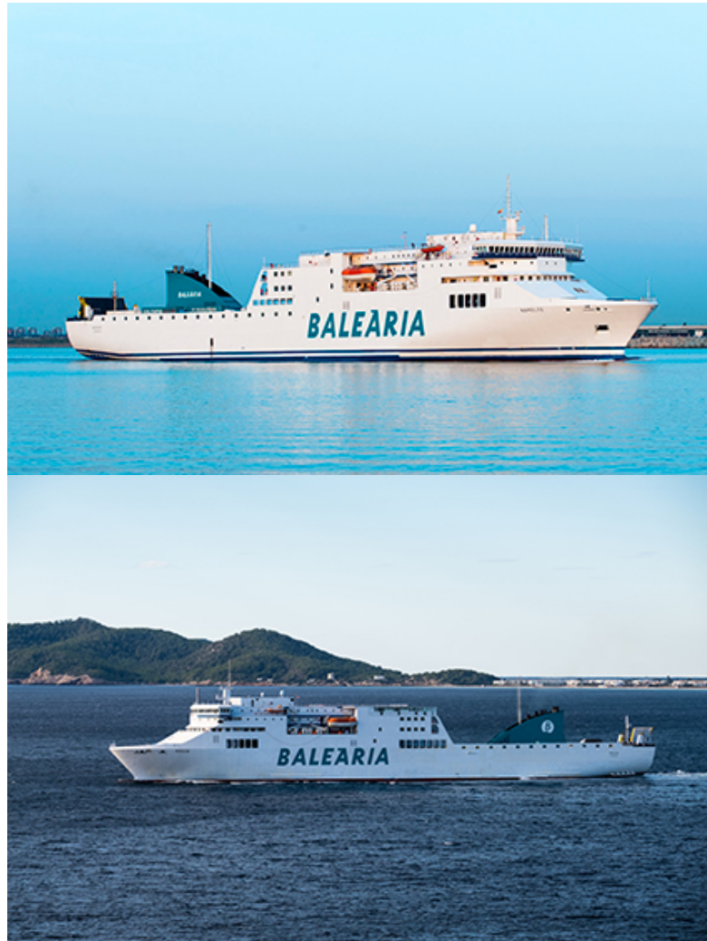
Baleàrias RoRo-Fähren 'Napoles' (oben) und 'Sicilia', deren Hauptmotoren vom Typ MAN 9L48/60A nach dem neuen Vertrag zu LNG-fähigen MAN 9L51/60DF-Motoren umgerüstet werden (Bilder mit freundlicher Genehmigung von Baleària)
