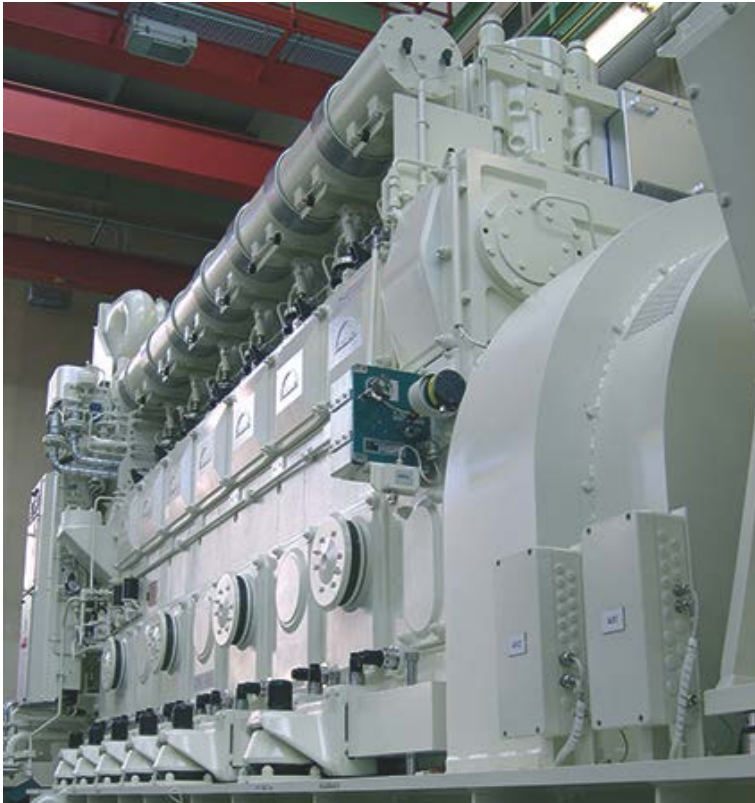
32/40 Motor von MAN Diesel & Turbo, hier als 7-Zylinder-Hilfsmotor abgebildet
